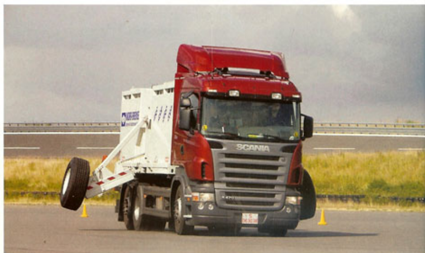
O estabilizador impede que o Scania capote. Ele atua freando as rodas para recuperar o apoio.
