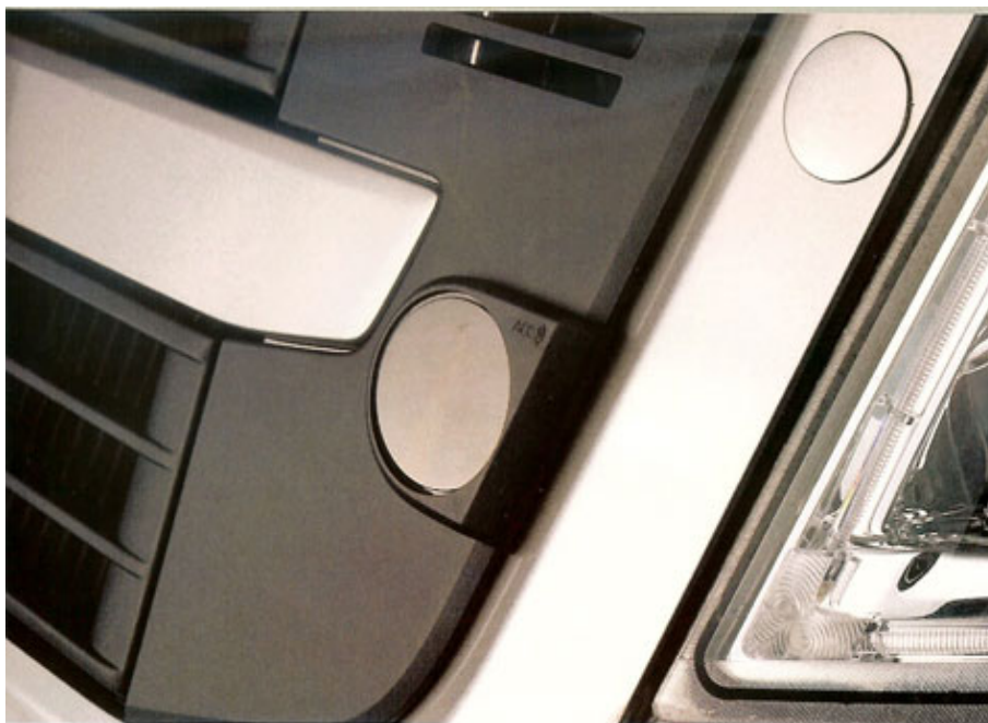
O ACC atua por meio de um radar que alerta o motorista para aproximação de outro veículo.
