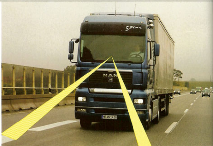
O leitor de faixa trabalha com o piloto automático e alerta o motorista sobre desvio.
