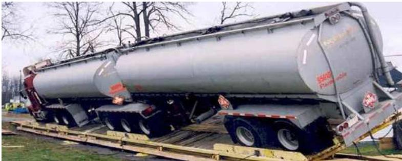
Calculando ou no ensaio “*tilt table*”: a plataforma é inclinada até o momento que os pneus perdem o contato com o piso. A tangente do ângulo capaz de provocar esse efeito corresponde ao valor do SRT do conjunto em g’s.
