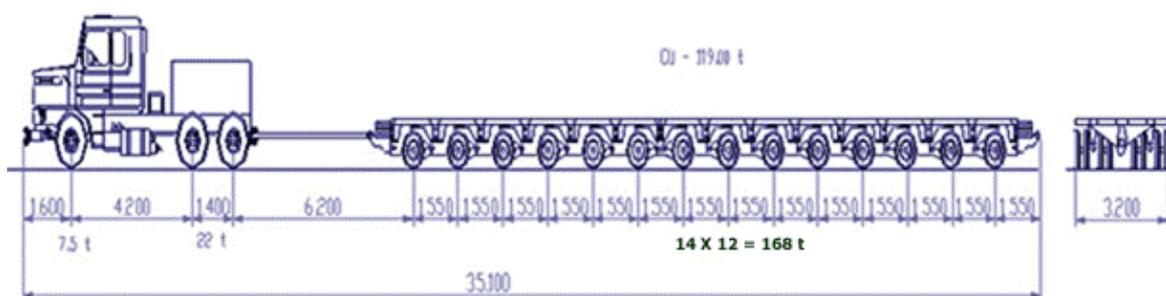
**NOTA 1:** cargas com até os limites acima dispensavam estudo viabilidade e podiam ser transportadas sem a necessidade de distribuidor de carga
