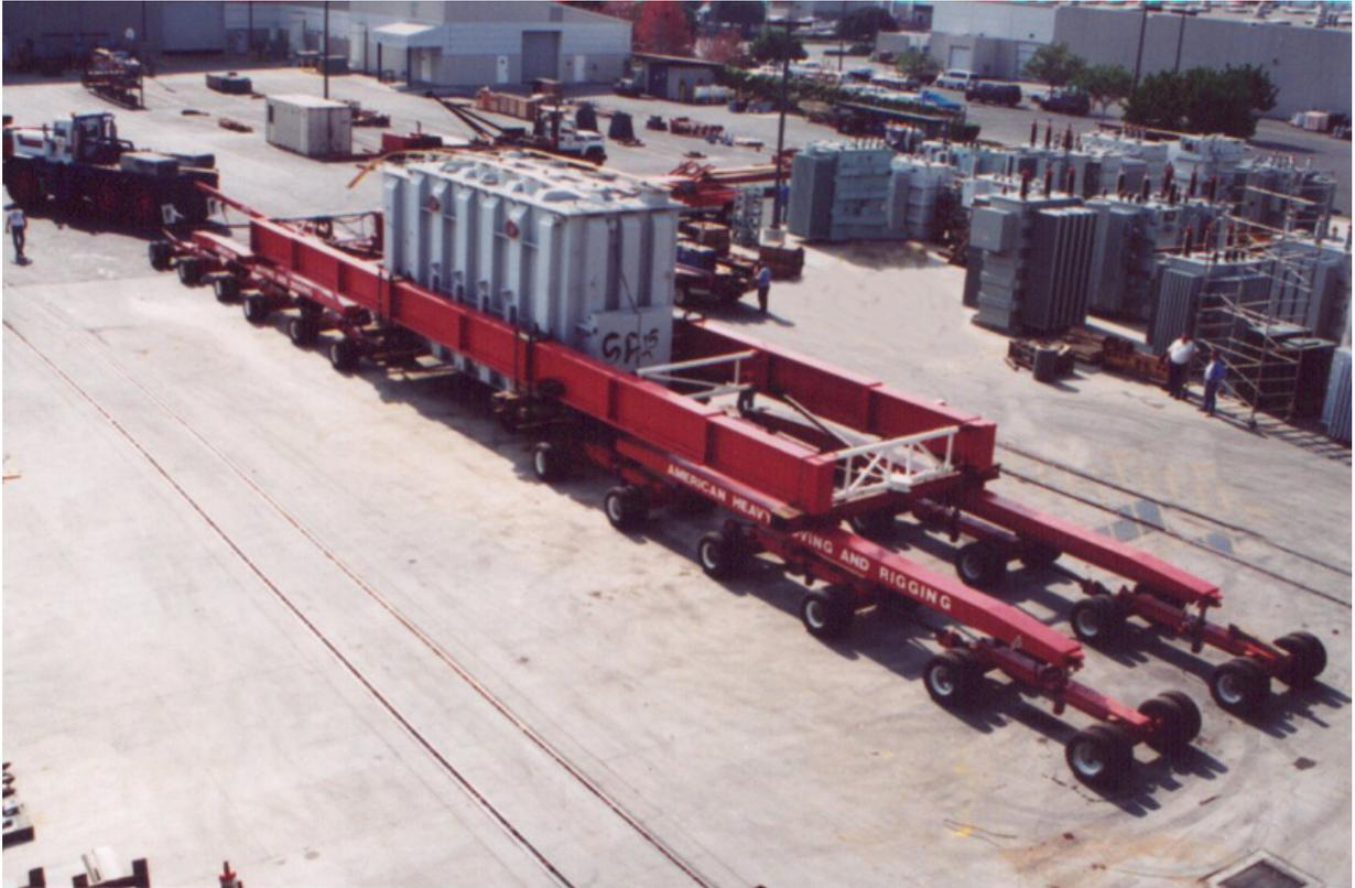
Chamamos à atenção ainda, para o fato de que o que o diagrama de carga do fabricante indica é a capacidade técnica em condições estáticas e de perfeita manutenção do reboque, devendo-se para as condições normais de operação reduzir em pelo menos 30% a capacidade de carga indicada na leitura do mesmo.
