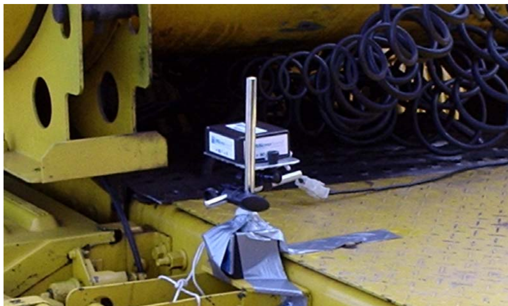
FIGURA 47 – Detalhe do Acelerômetro 1 no Veículo-trator.
